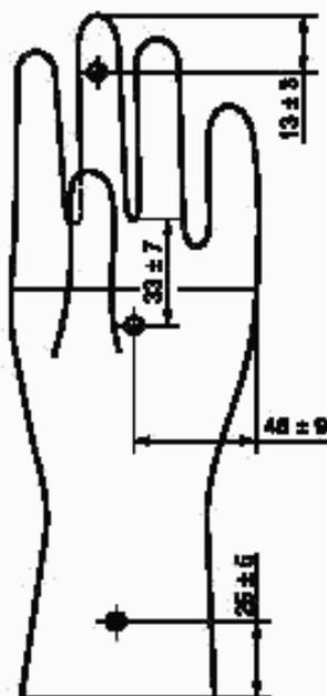
Рисунок 2 — Точки для измерения толщины стенки перчатки
